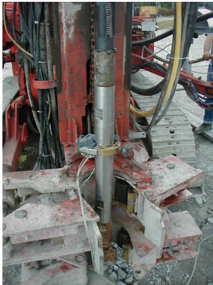
Abbildung 14: Ablesen der Bohrabweichung (TIGOR)
