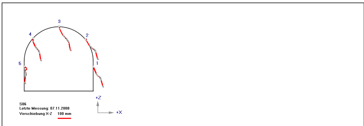
Bild 12: Verschiebung am Tunnelumfang
