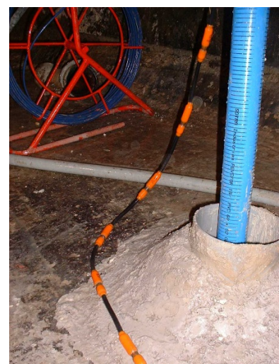
Abbildung 16: Messgerät und Versetzen der Elektrodenkette in das PVC-Rohr
