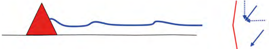
Fig.27 : Exemple de barrage empêchant l'écoulement d'eau sur une route (AEAI)
