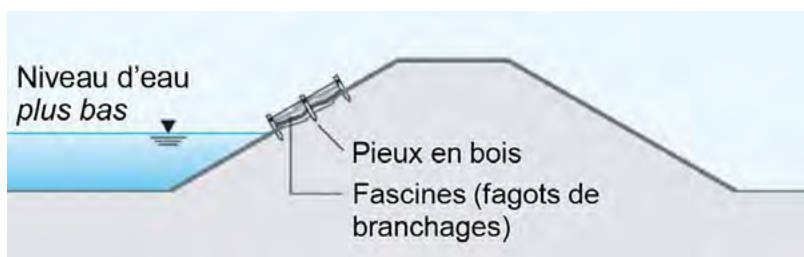
Fig. 78 : Mise en place de fascines dans une digue (Office bavarois de l'environnement)
