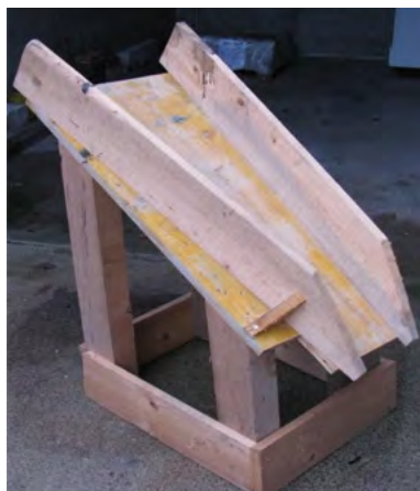
Fig. 32 : Rampe de chargement de sable (OFPP)
