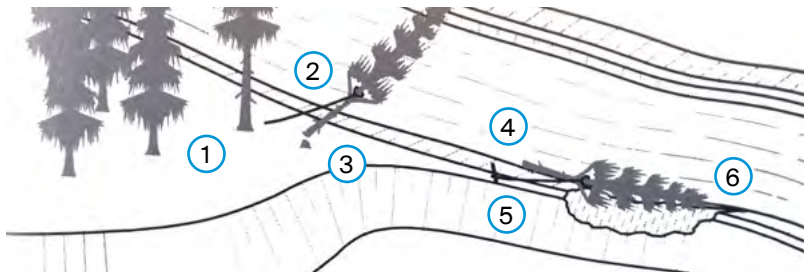
Fig. 82 : Mise en place d'un arbre entier disposé en épi (Rote Hefte 82, Kohlhammer Verlag)
