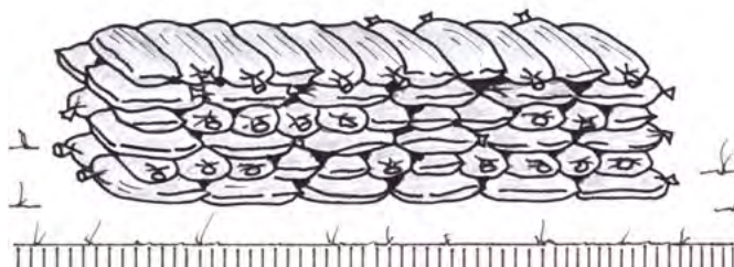
Fig. 51 : Empilement de sacs de sable en décalé (manuel de construction de l'Armée suisse).
